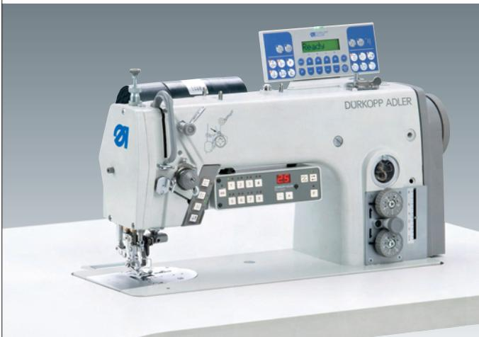
**275-742642-01 – mit Mehrweitensteuerung und elektromotorisch angetriebenem, zuschaltbarem Kantenschneider**
