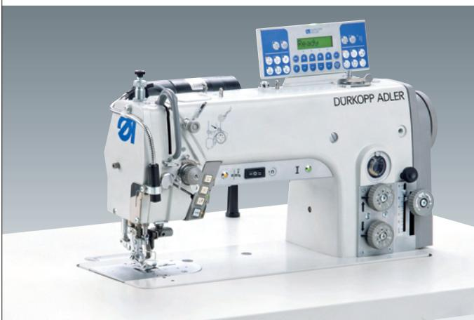
**275-740642-01 – mit elektromotorisch angetriebenem, zuschaltbarem Kantenschneider**
