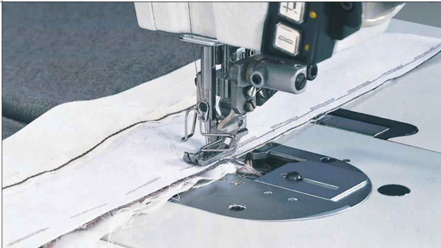
**275-740642-01 E104 (8 mm) – Bund aufnähen und gleichzeitiges beschneiden der Kante**
